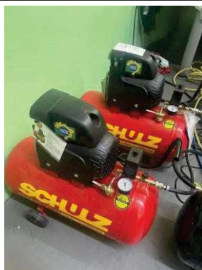
Foto 05 - compressor de ar
