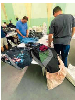
Foto 25: peças para ressignificação simples sendo preparadas para aplicação de hotstamp sobre as logomarcas
